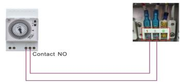
Raccordement direct pour le pilotage de la pompe de filtration, « mode priorité chauffage »
